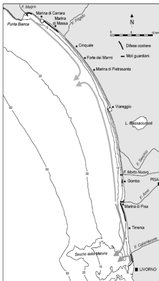
Fig. 11 - Direzione del trasporto litoraneo (longshore transport) all'interno dell'Unità Fisiografica Bocca di Magra-Livorno.
