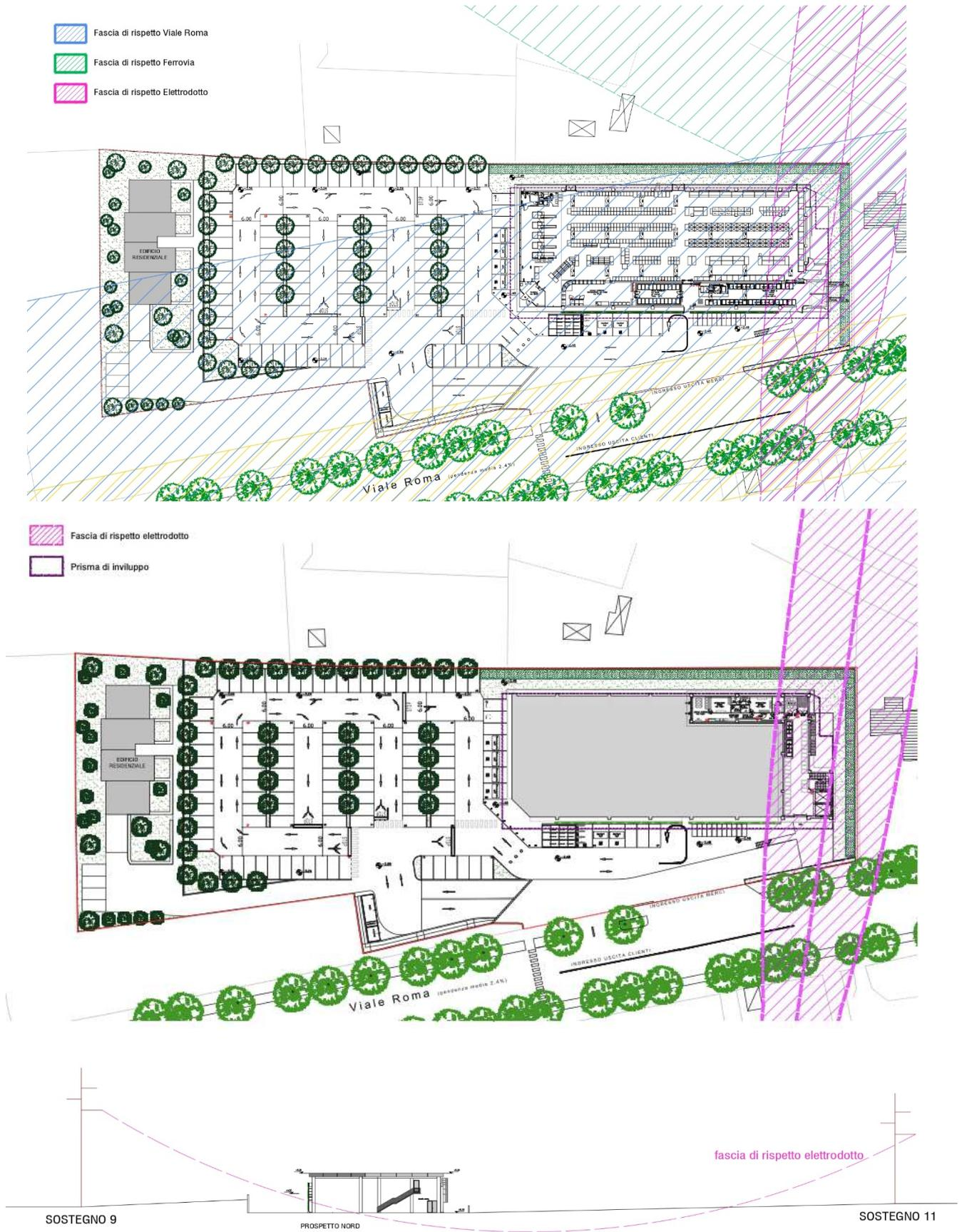
Fig. 6.15 Pianta piano terra (in alto) e primo piano (centro) e sezione (in basso): interferenza con elettrodotto
